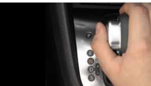
**D = „Dauer“- oder Normalprogramm:** Programm fürs Vorwärtsfahren. Das DSG schaltet automatisch durch die Vorwärtsgänge – hinauf oder herunter, je nachdem, welcher Gang erforderlich ist. Treten Sie beim Halten im D-Programm das Bremspedal, damit der Wagen nicht langsam vorfährt, z. B. vor einer Ampel.
