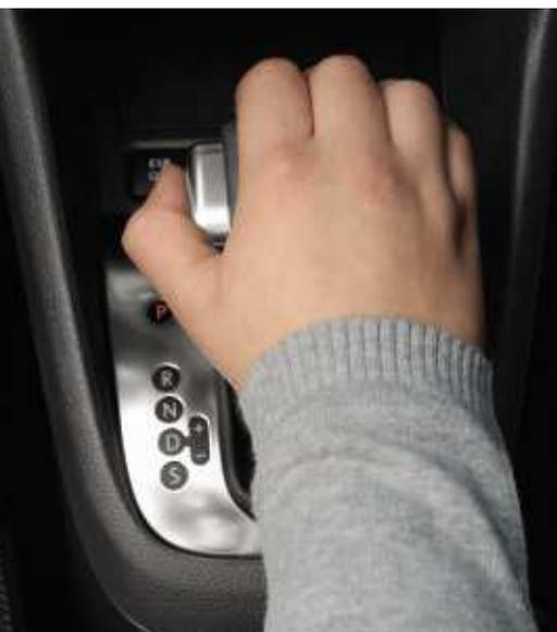
**P = Parkstellung:** Zum Einlegen oder Verlassen der P-Stellung müssen Sie die Sperrtaste oben links am Wählhebel drücken. Der Zündschlüssel kann nur in dieser Position abgezogen werden.
