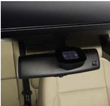
Aktiviert bei einsetzendem Regen automatisch die Scheibenwischer – ein wichtiger Beitrag zur aktiven Fahrsicherheit.
