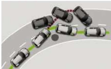
ESP arbeitet in Kombination mit → ABS, → ASR und → EDS, und zwar schneller, gezielter und zuverlässiger als jeder Mensch reagieren kann. Bei Bedarf, z. B. zum Anfahren im Tiefschnee, kann ESP abgeschaltet werden.
