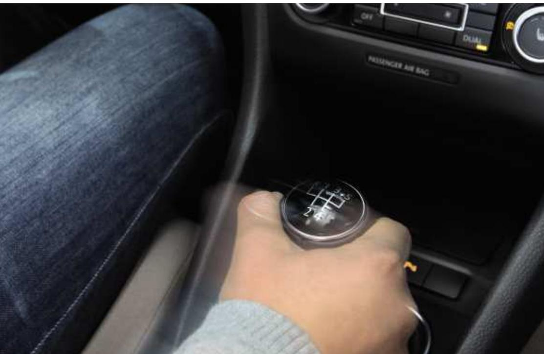
Bringen Sie den Schalthebel in die Leerlauf-Stellung. Treten Sie das Kupplungspedal durch. Beim Golf mit Doppelkupplungsgetriebe DSG muss der Wählhebel in P- oder N-Stellung sein und das Bremspedal getreten werden. Eine detaillierte Beschreibung der Pedale und der Bedienung von Schalthebel und DSG-Wählhebel finden Sie auf den folgenden Seiten.
