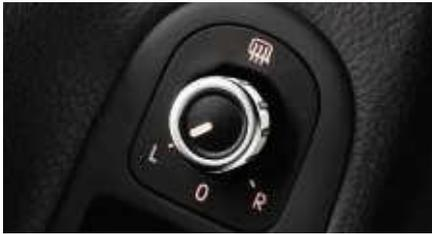
Per Knopfdruck lassen sich die Außenspiegel auf Fahrer- und Beifahrerseite präzise und schnell einstellen. Bei Frost oder hoher Luftfeuchtigkeit gibt es kein Vereisen oder Beschlagen der Spiegelflächen.
