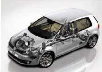
Permanenter Allradantrieb für optimale Traktion, mehr Fahrstabilität und aktive Sicherheit – z. B. bei sportlicher Fahrweise, schlechtem Wetter oder rutschiger Fahrbahn.
