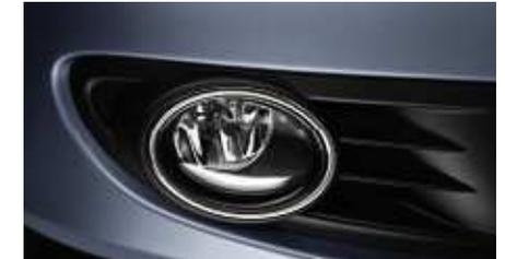
Bieten bei Nebel oder Schneefall eine deutlich bessere Fahrbahnausleuchtung. Das integrierte Abbiegelicht leuchtet bei eingeschlagenem Lenkrad oder betätigtem Blinker den Abbiegebereich aus – für bessere Sicht und höhere Sicherheit.
