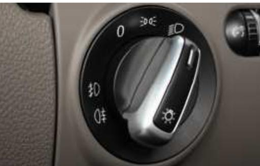
**Achtung!** Wegen der starken Blendwirkung darf die Nebelschlussleuchte nur bei Sichtweiten unter 50 Meter eingeschaltet werden.
