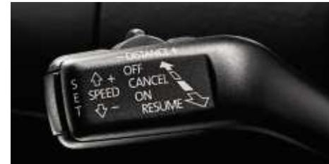
Hält die eingestellte Geschwindigkeit ab 30 km/h konstant, soweit es Motorleistung bzw. Motorbremswirkung zulassen. Sorgt besonders auf langen Strecken und bei Geschwindigkeitsbegrenzungen für ein entspanntes Fahren.
